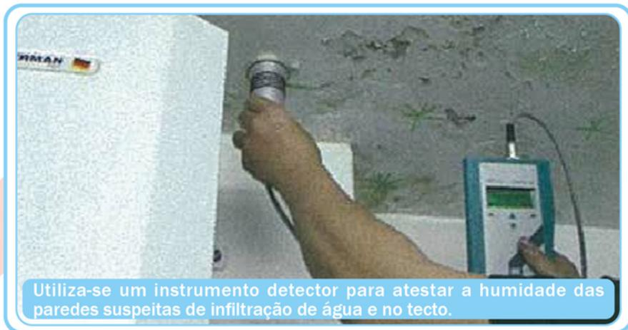
Utiliza-se um instrumento detector para atestar a humidade das paredes suspeitas de infiltração de água e no tecto.
