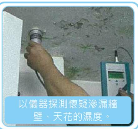
以儀器探測懷疑滲漏牆壁、天花的濕度。
